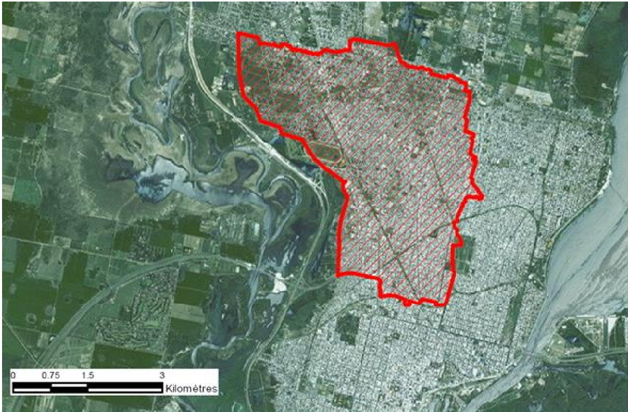
Figura 14 – Cuenca hidrográfica de las aguas pluviales recogidas por los reservorios 4 y 5 de la zona del proyecto – Fuente: Artelia
